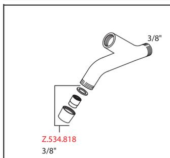
Auslaufmenge 12 l/min (3 bar)
