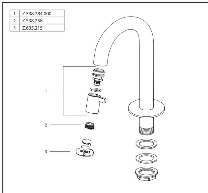
Auslaufmenge 5 l/min (3 bar)
