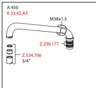
Auslaufmenge 50 l/min (3 bar)
