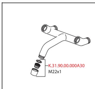
Auslaufmenge 14 l/min (3 bar)
