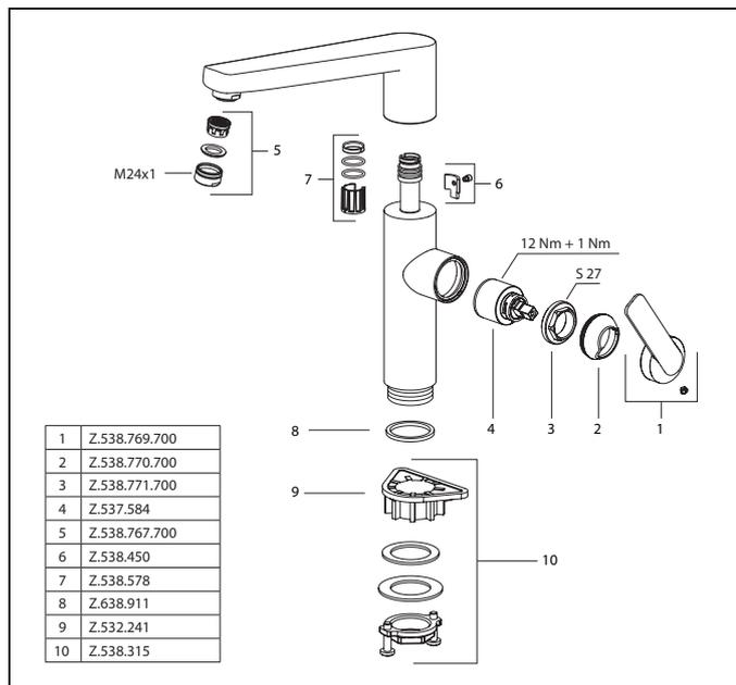
Auslaufmenge Normalstrahl 8 l/min (3 bar)
