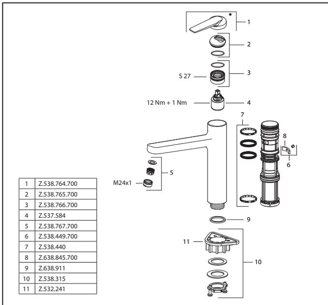
Auslaufmenge Normalstrahl 8 l/min (3 bar)
