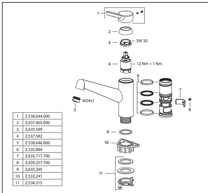
Auslaufmenge Normalstrahl 10 l/min (3 bar)
