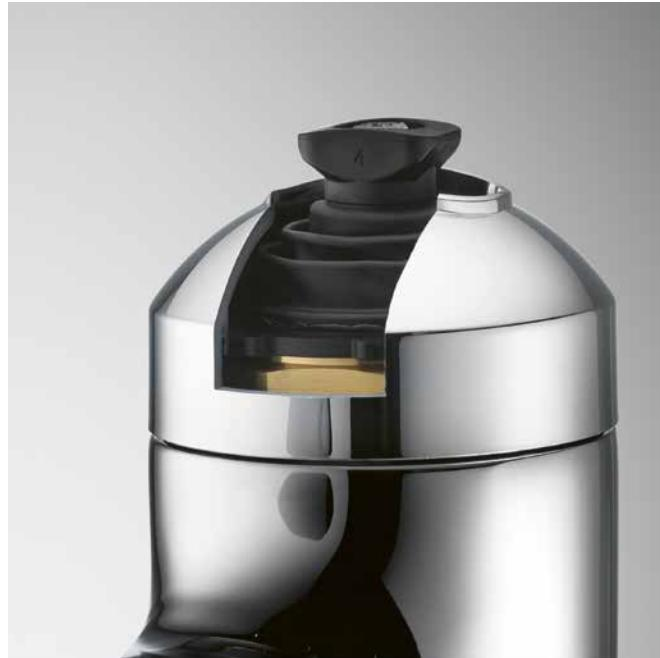
Questa innovativa membrana assicura alla vostra rubineria una tenuta di lunga durata e protegge la cartuccia di comando da sporcizia e residui di detergenti. L'alloggiamento della leva è integrato nella membrana e rinforzato da un cuore metallico per evitare che la leva si allenti.
