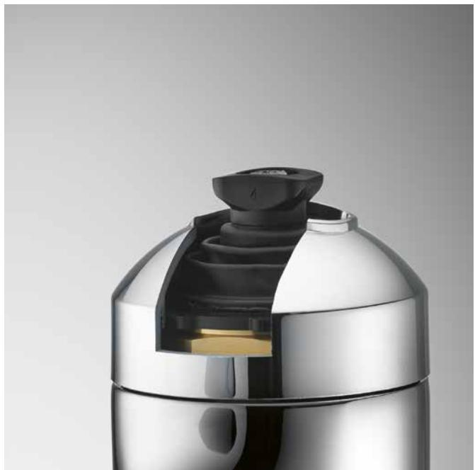
Questa innovativa membrana assicura alla vostra rubinetteria una tenuta di lunga durata e protegge la cartuccia di comando da sporcizia e residui di detergenti. L'alloggiamento della leva è integrato nella membrana e rinforzato da un cuore metallico per evitare che la leva si allenti.
