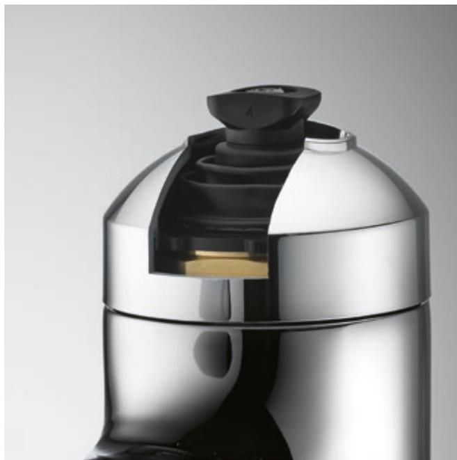
Questa innovativa membrana assicura alla vostra rubinetteria una tenuta di lunga durata e protegge la cartuccia di comando da sporcizia e residui di detersivi. L'alloggiamento della leva è integrato nella membrana e rinforzato da un cuore metallico per evitare che la leva si allenti.
