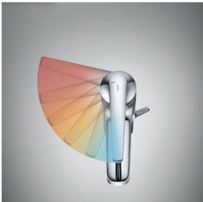
CoolFix bewahrt der KWC DOMO einen kühlen Kopf und hilft beim Energiesparen. In der meist gebrauchten Mittelstellung des Bedienungshebels fließt Kaltwasser. Erst wenn der Hebel nach links gedreht wird, kommt warmes Wasser hinzu.
