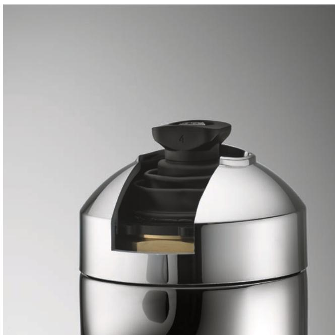
Cette membrane d'étanchéité innovante assure l'étanchéité durable de votre robinetterie. Elle protège la cartouche de commande des résidus laissés par les produits de nettoyage et les saletés. Renforcé par un noyau métallique, le logement du levier est intégré à la membrane et empêche de manière fiable que le levier ne se détache.
